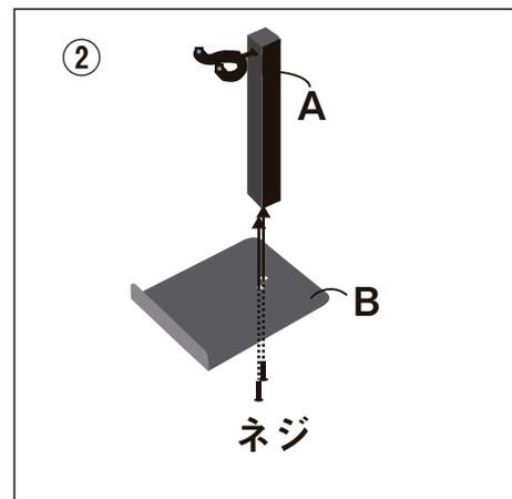
②「Aのパーツ」の穴と「Bのパーツ」の穴を合わせて裏側から「ネジ」で取り付けます。この時しっかりと締め込んで下さい。
